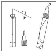
**Schritt 3** Nehmen Sie die Testkassette aus dem Folienbeutel und legen Sie sie auf eine ebene Fläche. Drücken Sie das Fläschchen zusammen, um drei (3) Tropfen der extrahierten Probe aus dem Extraktionsfläschchen in die Probenvertiefung der Testkassette hinzuzufügen. Lesen Sie das Testergebnis 15 Minuten nach dem Eintropfen der Probe ab, jedoch nicht später als 30 Minuten.
