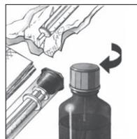
9. Nach Gebrauch die Messpipette **lediglich auf der Außenseite** mit einem **trockenen** Papiertaschentuch reinigen und wieder in die Schutzhülle zurücklegen. Der weiße Stopfen mit der Überleitungschanüle ist in der Flasche zu belassen. Die Flasche mit beiliegendem Schraubdeckel verschließen.
